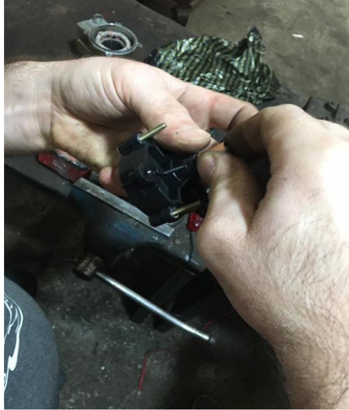
Şekil 4.12: Motorun Plastik Başlığının Monte için hazırlanması
