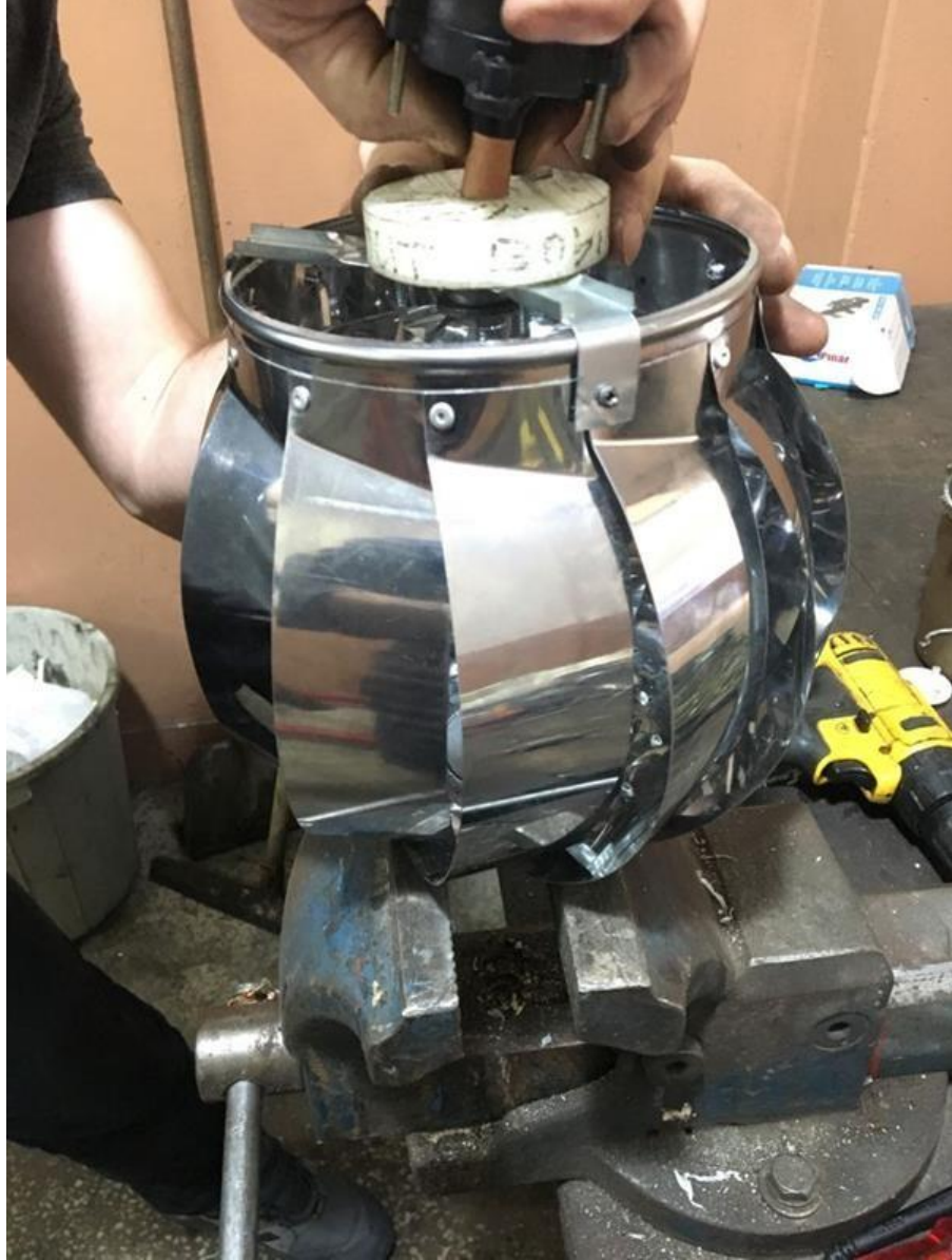
řekil 4.13: DC Dinamo Motorun Plastik Köprüye Monte Edilmesi
