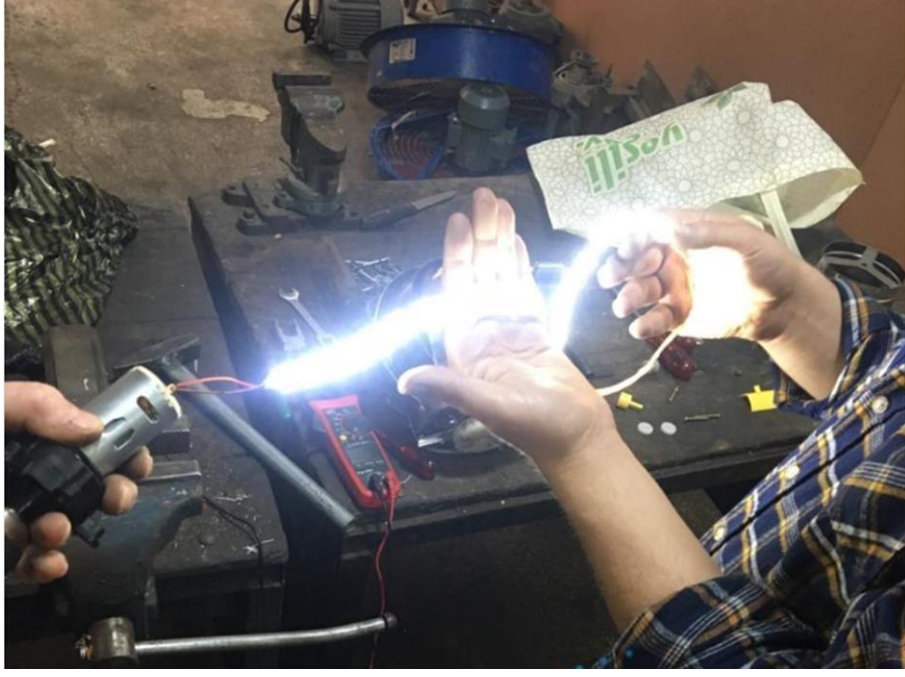
Şekil 4.9: DC Dinamo Motorun Aktif Hale Getirilmesi ile Yanan LED
